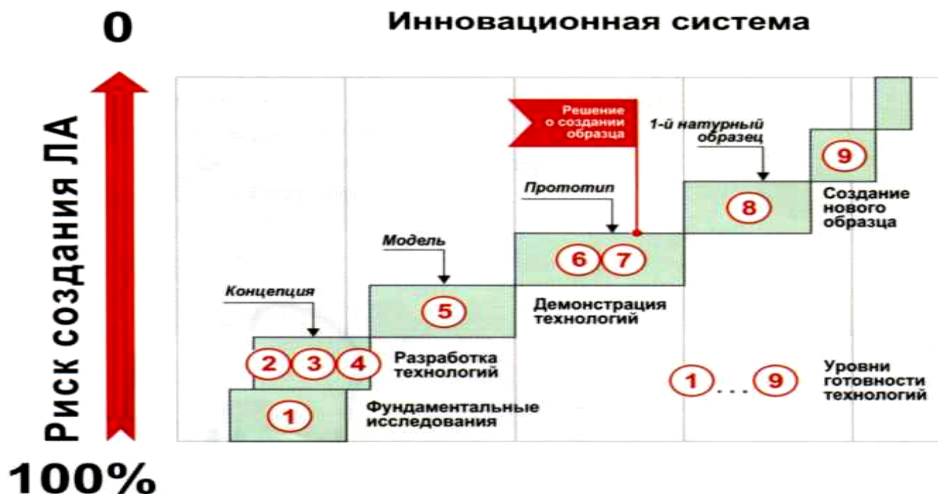
Рисунок 3. Система (этапность) разработки СТС (АТ), принятая в странах Запада
