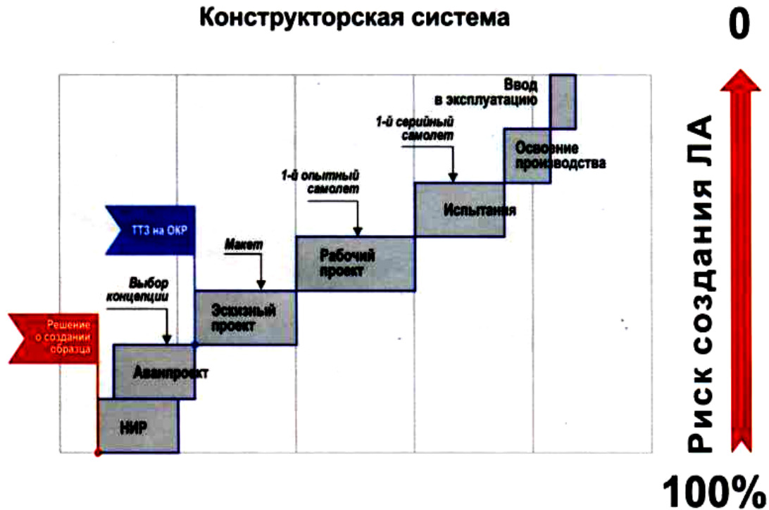
Рисунок 2. Последовательность этапов разработки АТ, принятая в России
